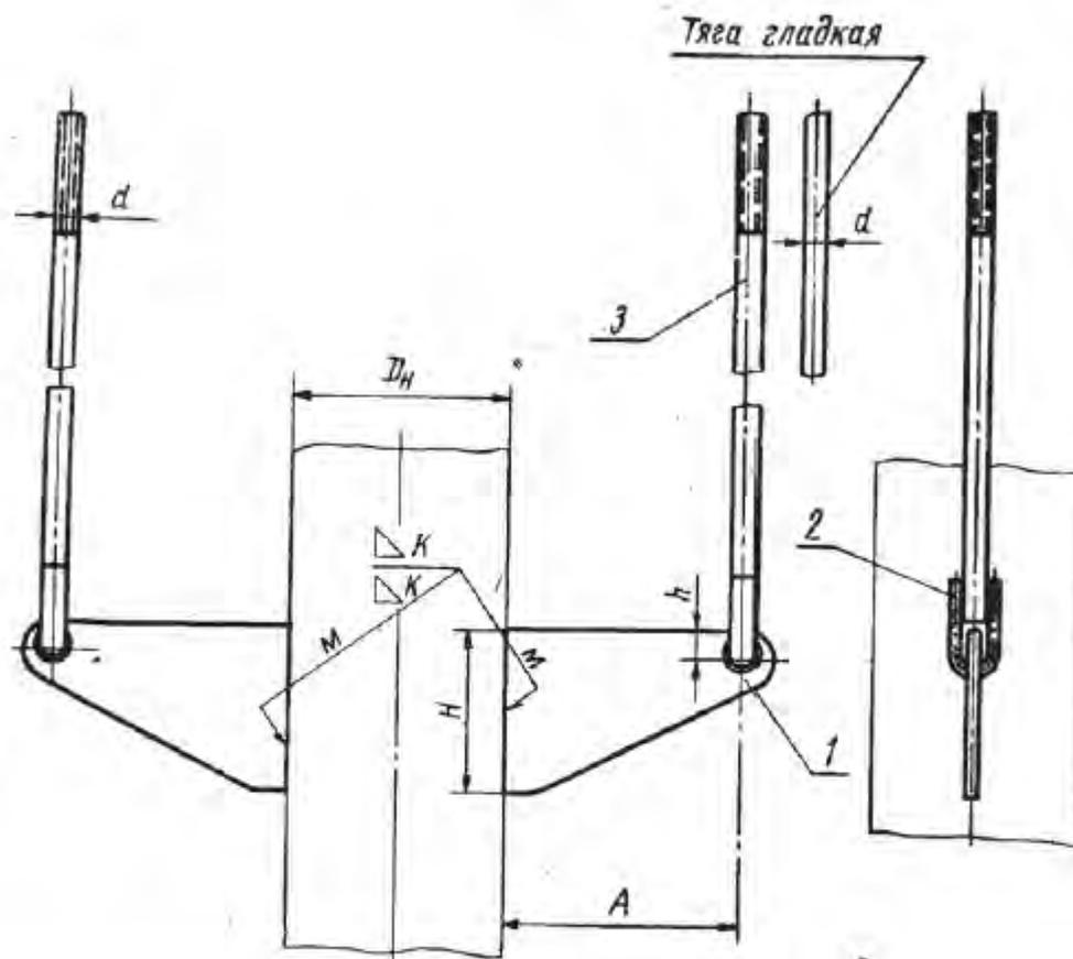
Пример обозначения блока подвески для трубопровода  $D_n=68$  мм с тягой  $d=M10$ :
