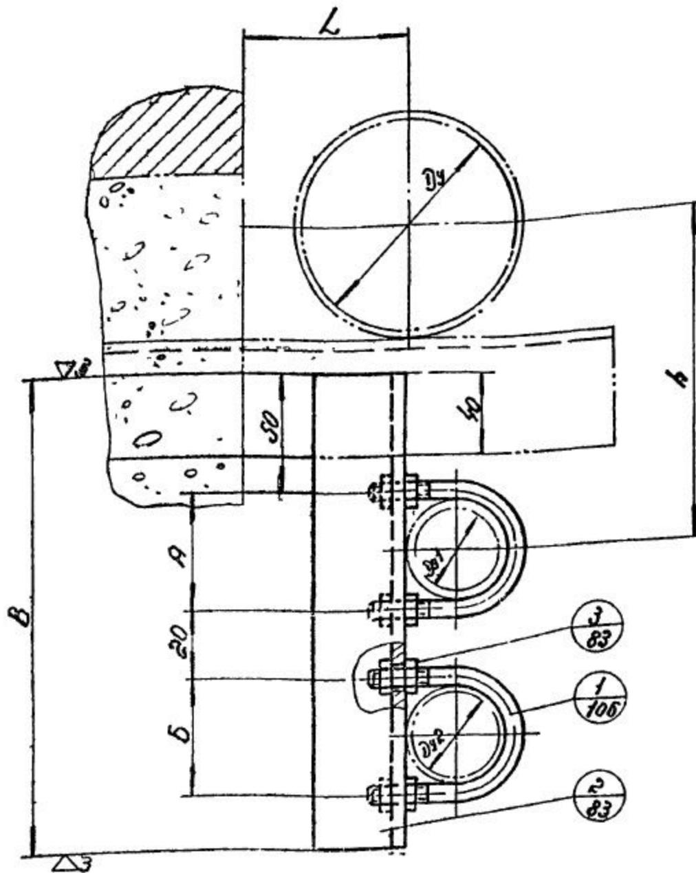
Пример условного обозначения крепления 2-х вспомогательных газопроводов Ду<sub>1</sub> - Ду<sub>2</sub> к горизонтальному газопроводу Ду 100 КВС Ду<sub>1</sub> - Ду<sub>2</sub> - 100
