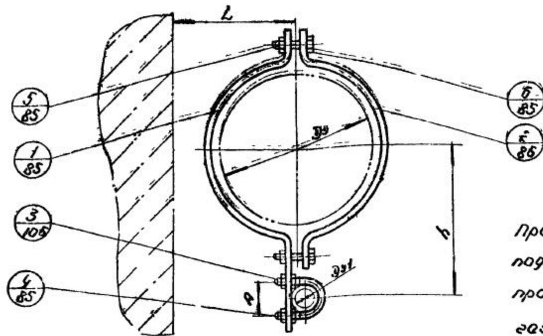
Пример условного обозначения подвески вспомогательного газопровода  $Dy 25$  к горизонтальному газопроводу  $Dy 100$  ИВС 25-100, УКГ-74
